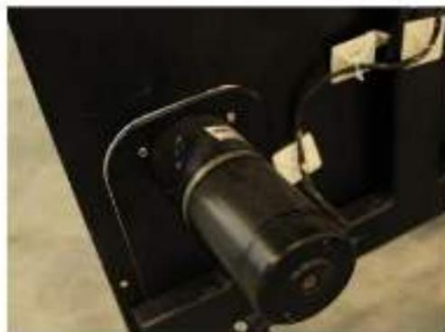
Inicie o procedimento de troca desconectando o cabo de alimentação do motor, localizado no ponto J2 (Ofeeding) na placa driver. Depois solte as partes do cabo presas ao chassi;
