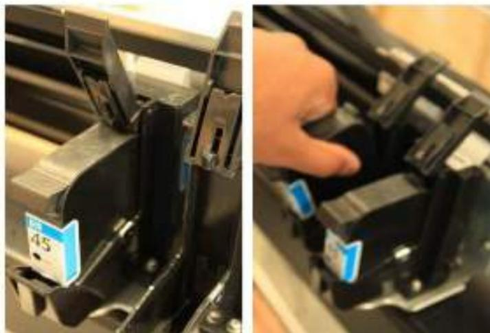
Encaixe o cartucho no carro de impressão e, após ter encaixado, empurre-o para baixo e baixe a trava preta do suporte de cartucho;
