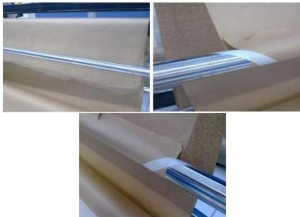
Retire a haste da bailarina (localizada na parte posterior do plotter) e encoste o papel no eixo central do plotter. Estique a haste para baixo, até chegar ao sensor;
