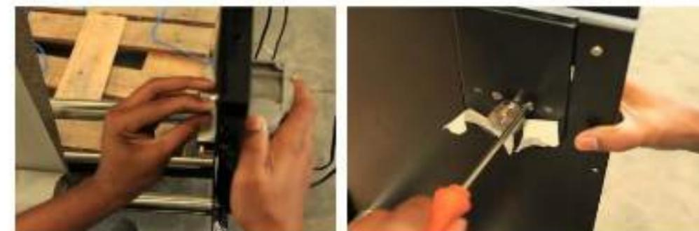
Feita a fixação do motor recoloque o mancal, reconecte o cabo de alimentação do motor na placa driver e prenda novamente os fio ao chassi da máquina. Faça um teste de funcionamento do plotter. Ocorrendo tudo certo recoloque a carenagem no plotter.
