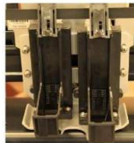
Após isso, observe que há três parafusos que fixam o suporte de cartucho, com a chave Allen 2 mm, desparafuse-os;
