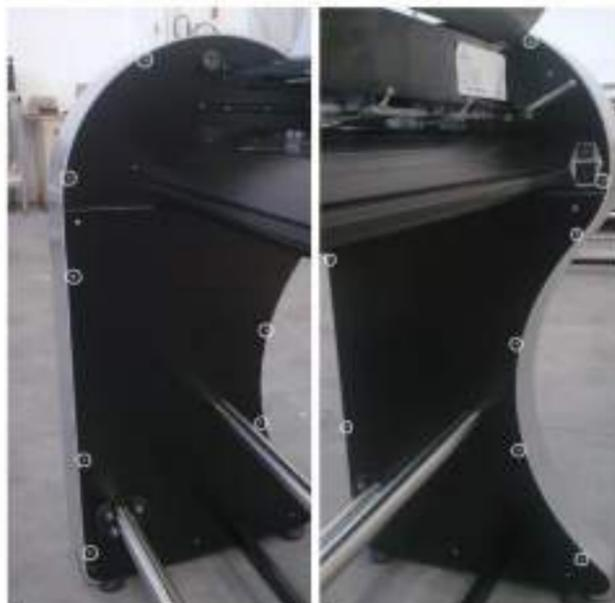
Um cuidado é necessário para remover a carenagem lateral direita, pois há um cabo ligando a carenagem e a placa CPU.
