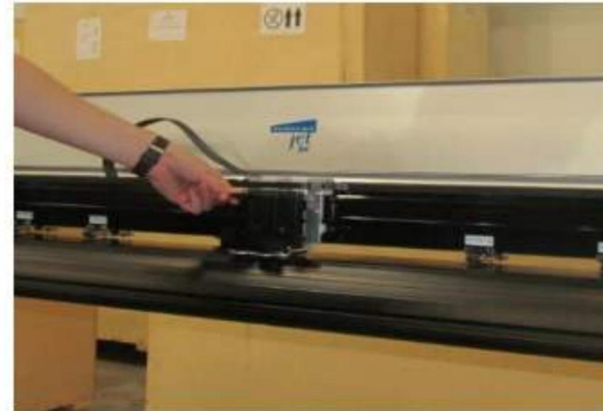
Faça a retirada do plástico bolha do tubo bobinador e das bailarinas.
