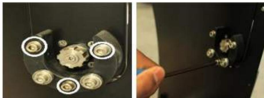
Após retirar o mancal, os parafusos de fixação do motor ficaram a mostra, com a chave Philips, desparafuse-os atentando para as arruelas que poderão se soltar;
