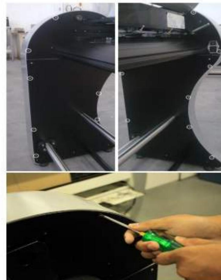
Na remoção da carenagem lateral direita deve-se ter o cuidado, pois há um cabo ligando o teclado da lateral com a placa CPU;
