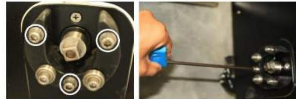
Após retirar o mancal, os parafusos de fixação do motor ficaram a mostra, com a chave Philips, desparafuse-os;
