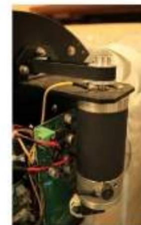
Inicie o procedimento de troca desconectando todos os cabos e correia ligados a ele;
