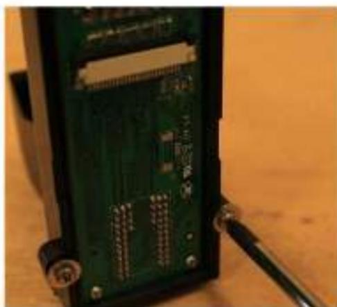
Faça a substituição pela placa interface nova e parafuse ela no suporte de cartucho;
