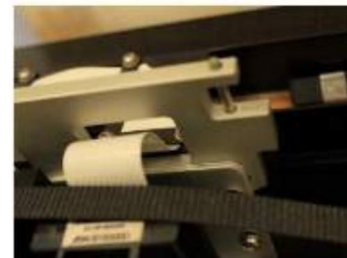
Próximo passo será desparafusar os dois parafusos que fixam a placa interface no suporte de cartucho;
