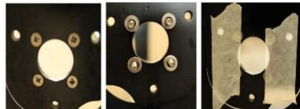
Ao reposicionar o motor, com uma das mãos segure os parafusos e com a outra encaixe o motor no local. Depois faça o aperto dos parafusos no motor.
